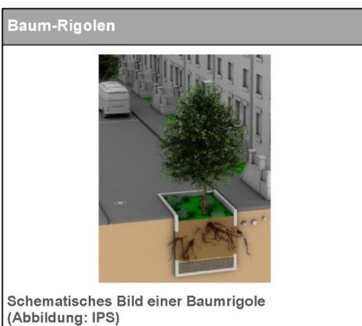
Schematisches Bild einer Baumrigole (Abbildung: IPS)
