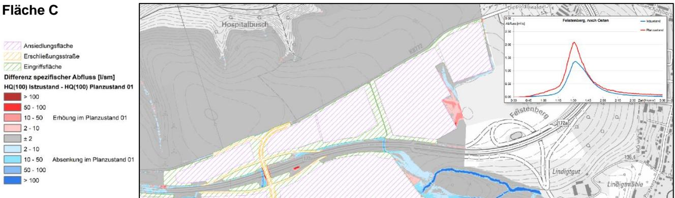
*Abb. 7: Differenzdarstellung zwischen Ist- und Plan-Zustandes ohne Rückhaltemaßnahmen für Fläche C [3]*
