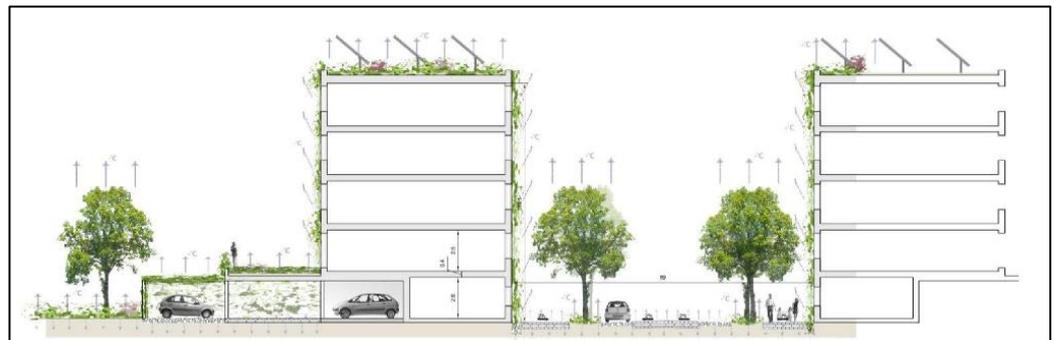
Abb. 16: Maßnahmenbündel der dezentralen Regenwasserbewirtschaftung auf Gebäude/ Grundstücksebene, Beispiel aus KURAS-Leitfaden<sup>1</sup>.
